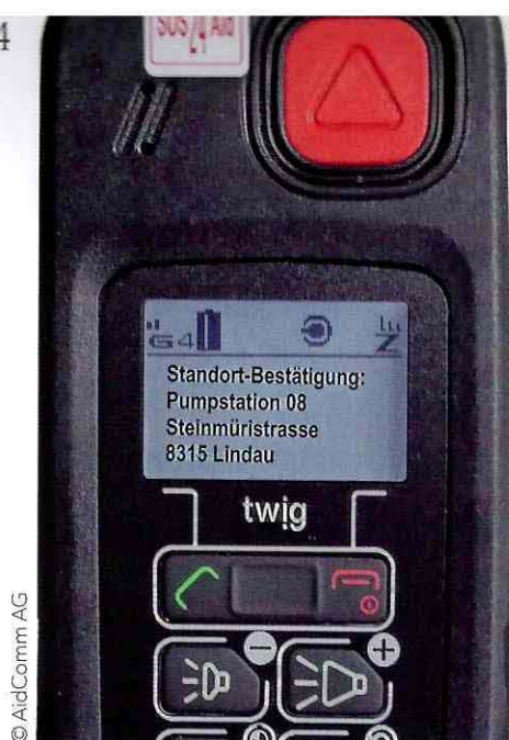
NFC-Ortsmarke per Knopfdruck erfassen mit AidComm One.
